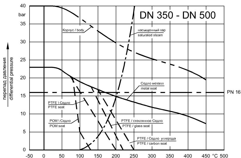
При использовании седельных колец из PEEK или POM против рекомендуемого направления давления макс. перепад давления составляет 5 бар.
